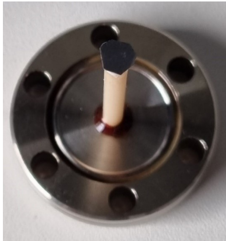
Abbildung 29: Fotografie der Thoriumprobe, welche auf einen Keramikstab geklebt wurde.
