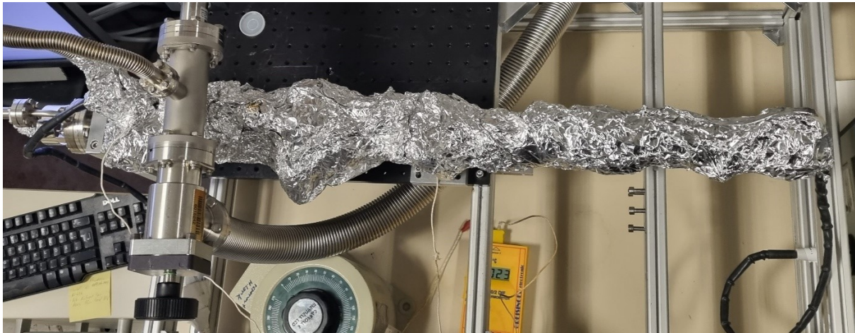
Abbildung 21: Ausheizen der Apparatur unter vermindertem Druck.
