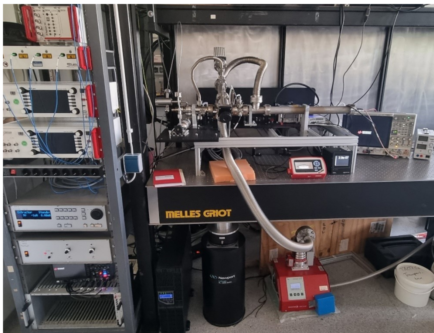
Abbildung 20: Fotografie der Laserablationsionenquelle mit eingebauter Kohlenstoffprobe und angeschlossener Xenon-Gasflasche (Stand 30.08.22). Links zu sehen sind die Kontrolleinheiten für die Ionenkanone und den Wienfilter (graue Kästen).
