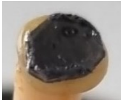
Abbildung 28: Fotografie der Kohlenstoffprobe nach Laserbeschuss.
