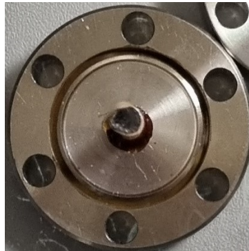
Abbildung 22: Fotografie der Kohlenstoffprobe, welche auf einen Keramikstab geklebt wurde.
