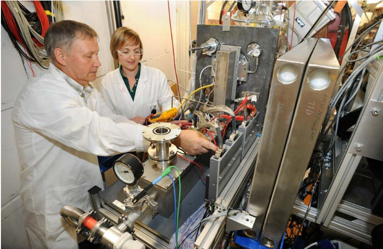
Dr. Alexander Yakushev, Leiter des Experiments, und Dr. Lotte Lens stellen die Messelektronik für den Nachweis des Zerfalls von Fleroviumatomen ein. Im Vordergrund ist die Vakuumkammer mit dem COMPACT-Chromatographiekanal zu sehen, im Hintergrund der letzte rote Magnet des TASCA-Separators. (Foto: G. Otto, GSI)
