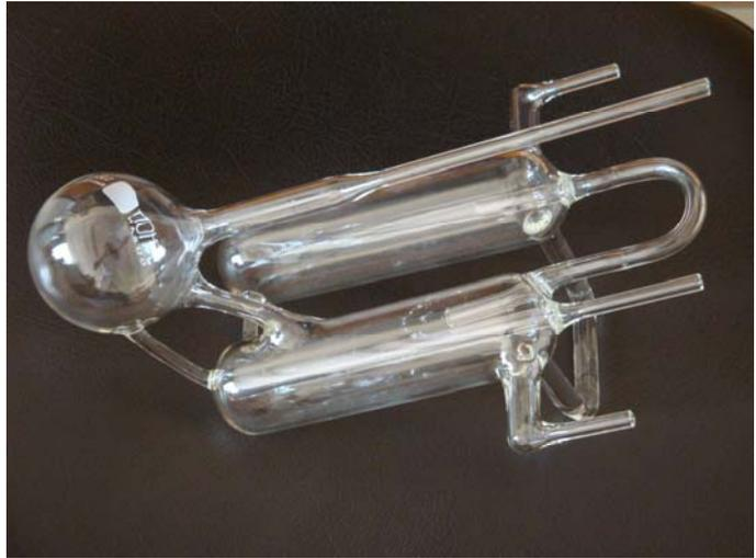
Abbildung 24, 25: Apparatur zur Verflüchtigung von Cyclopentadien
