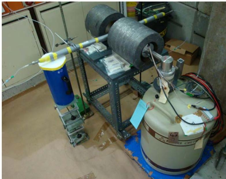
Abbildung 14: Thermochromatographie-Apparatur mit Detektor
