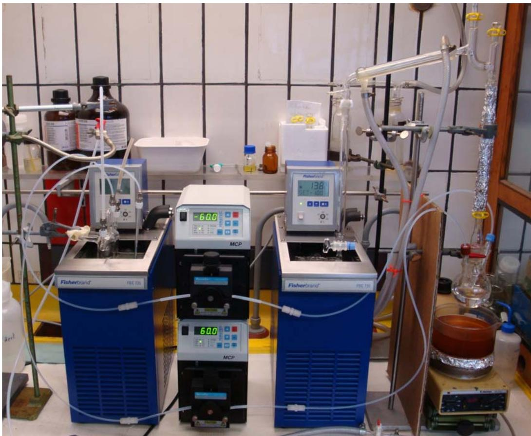
Abbildung 27: Apparatur zur Destillation und Verflüchtigung von Cyclopentadien
