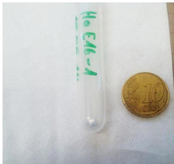
Abbildung 3.2: Gefaltete Titanfolie in einem Bestrahlungsröhrchen
